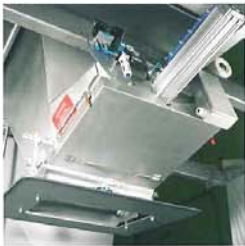
Trichter mit pneumatischem Schieber zur Vorportionierung der Teige.
